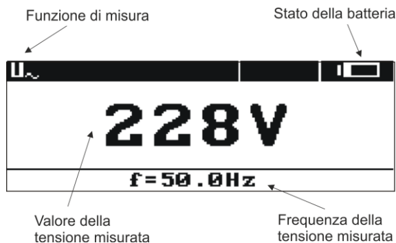
Fig. 2 Layout dello schermo durante la misurazione della tensione AC
