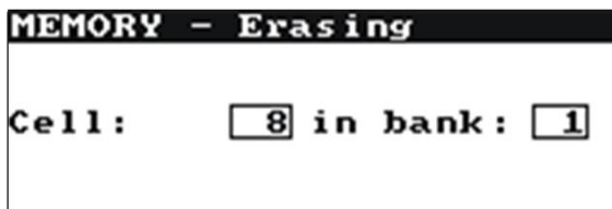
Fig. 29 Cancellazione della cella dalla memoria: 1 – numero di banco, 8 – numero di cella, [1] – il banco con almeno una cella occupata, [8] – cella occupata
