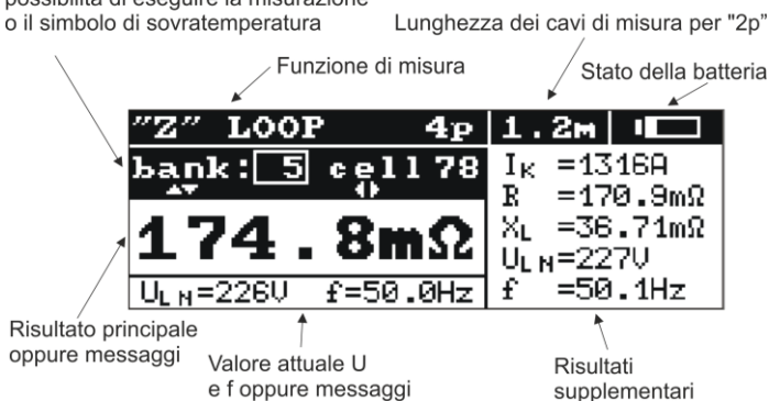
Fig. 3 Layout dello schermo durante la misura dell'impedenza dell'anello di guasto (tutti i risultati)
