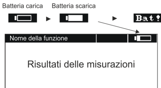
Fig. 34 Monitoraggio dello stato di carica della batteria
