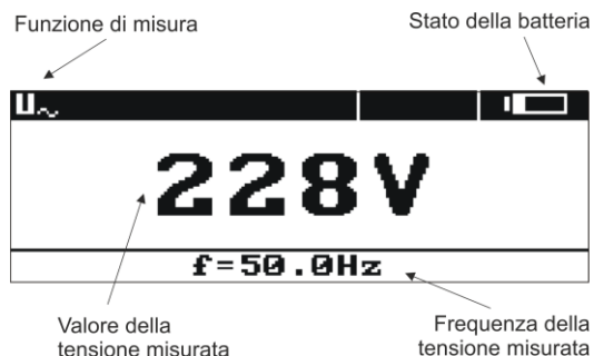
Fig. 12 Misura della tensione AC - risultato
