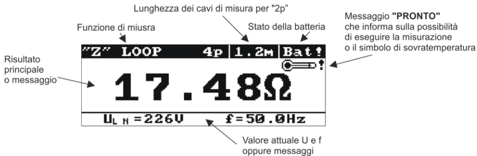
Fig. 4 Layout dello schermo durante la misura dell'impedenza dell'anello di guasto (solo il risultato principale)
